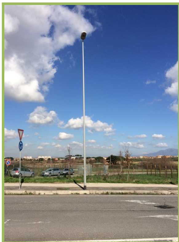
Armatura stradale con doppio isolamento (250 W S.A.P.)
