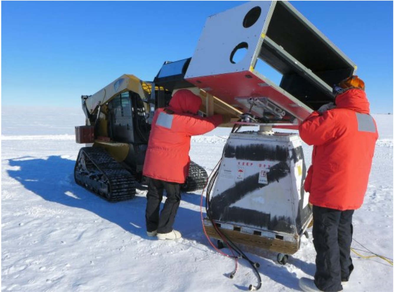
Fase del montaggio del canale nel Potassio (K) sulla montatura del telescopio.
