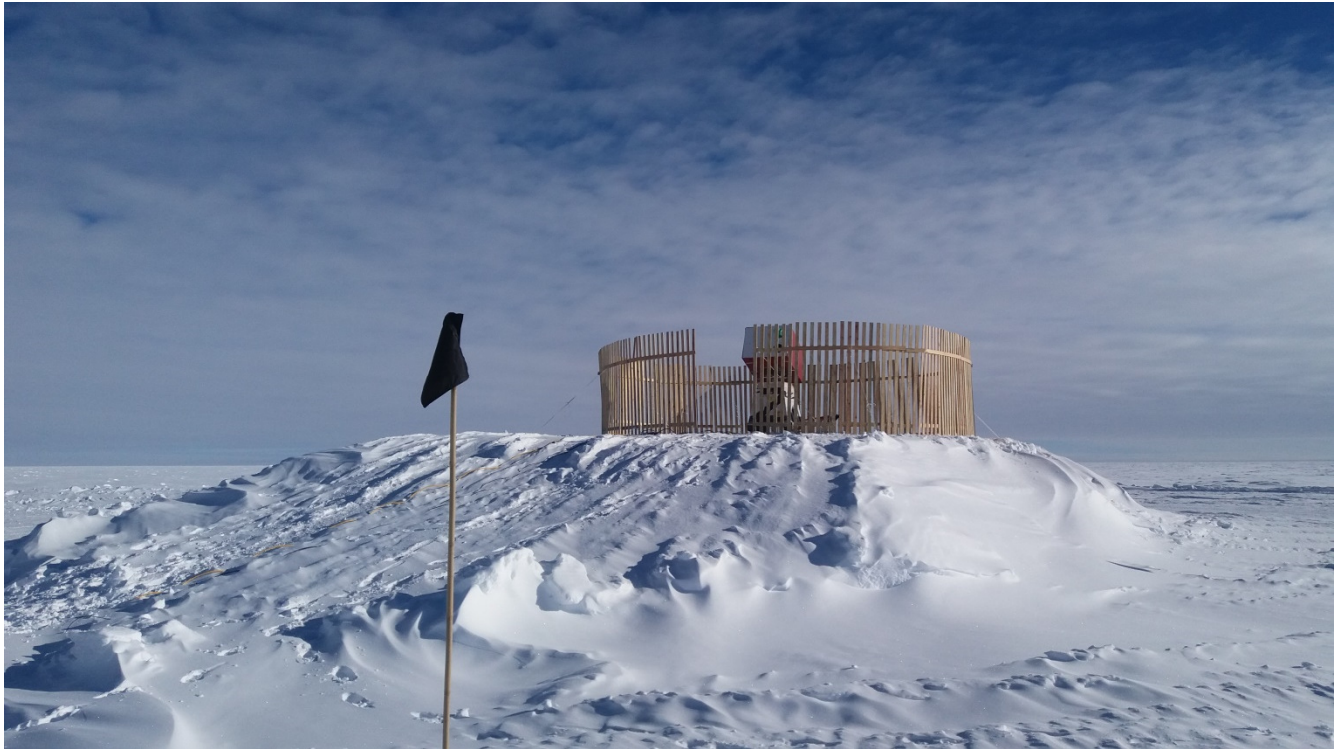
Telescopio montato con la struttura “Hammerschlag” per la soppressione del vento.
